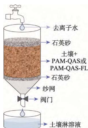
图 2 土壤淋溶装置示意图
